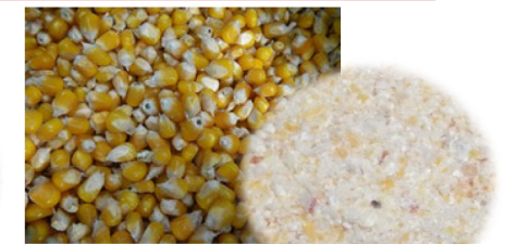
HMSC粉砕前と粉砕後 (粉砕機スクリーンは10mm使用)
