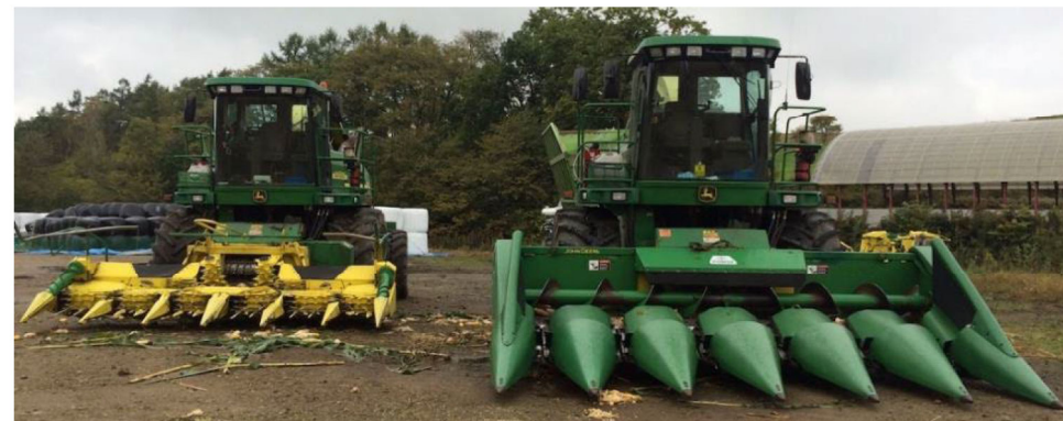
ホールクロープサイレージ収穫用ロータリーヘッド(左)と イアコーンサイレージ収穫用スナッパヘッド(右)を装着した自走式ハーベスタ
