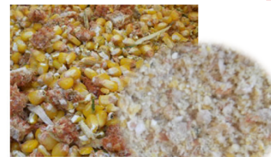
CCM粉砕前と粉砕後 (粉砕機スクリーンは10mm使用)
