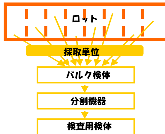
図 12 検査用検体をバルク検体から取り出す。多くの異なった採取単位から少量ずつ採取して集積したものをバルク検体と呼ぶ
