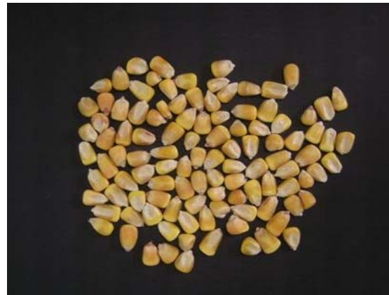
写真 3-1 トウモロコシを篩い分けした際に 7mm 篩上に残った穀粒
